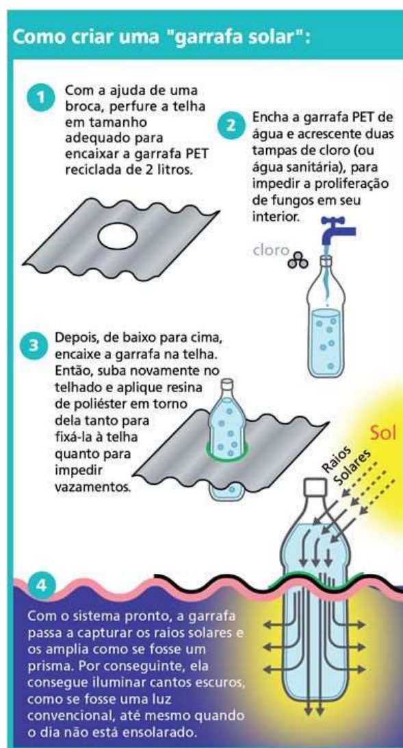
Figura 16 - Esquema de montagem da lâmpada diurna
